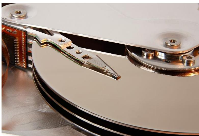
U strukturi GMR materijala ključan je sloj nemagnetnog metala između dva magnetna metala. Magnetni materijali teže da se poravnaju u istom smeru promena smera u jednom magnetnom sloju dovešće do istog poravnanja u sledećem sloju. Kada slabo magnetno polje, prođe pored GMR glave, magnetno usmerenje jednog od slojeva rotira u odnosu na smer u drugom sloju, što zbog GMR efekta dovodi do značajne promene električnog otpora.
